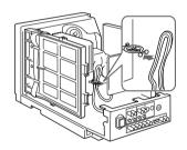
**14** (14インチモニターのみ) SDIボードの配線止めでモニターのケーブ ル (手順8の**①**ではずした)を固定する。
