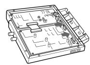
**⑤** 手順**①** ではずしたネジ8本を使ってSDI ボードのふたを取り付ける。
