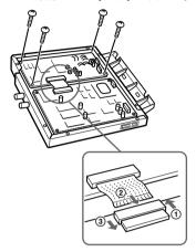
◆ BKM-102に付属の接続ケーブルで、BA 基板のCN1端子とBV基板のCN3端子、 BA基板のCN2端子とBV基板のCN4端子 を接続する。
