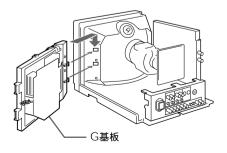
**4** (20インチモニターのみ) 付属の20インチモニター用取り付け金具を モニターに取り付ける。
