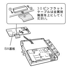
3 30ピンフラットケーブルをBV基板の CN5端子に差し込み、BA基板をBKM-102に付属のネジ(4本)で留める。
