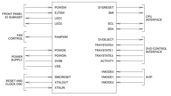
Figure 17. SMC IO Diagram
